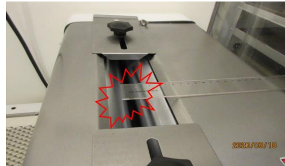
被吐司整型機滾筒捲夾之處所
