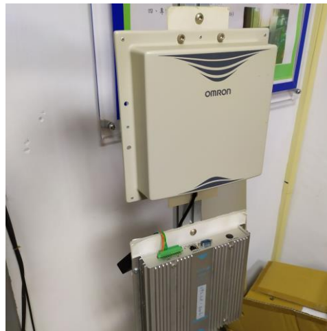
左方照片為設備全貌，右方照片為固定式無線追蹤讀取設備。
