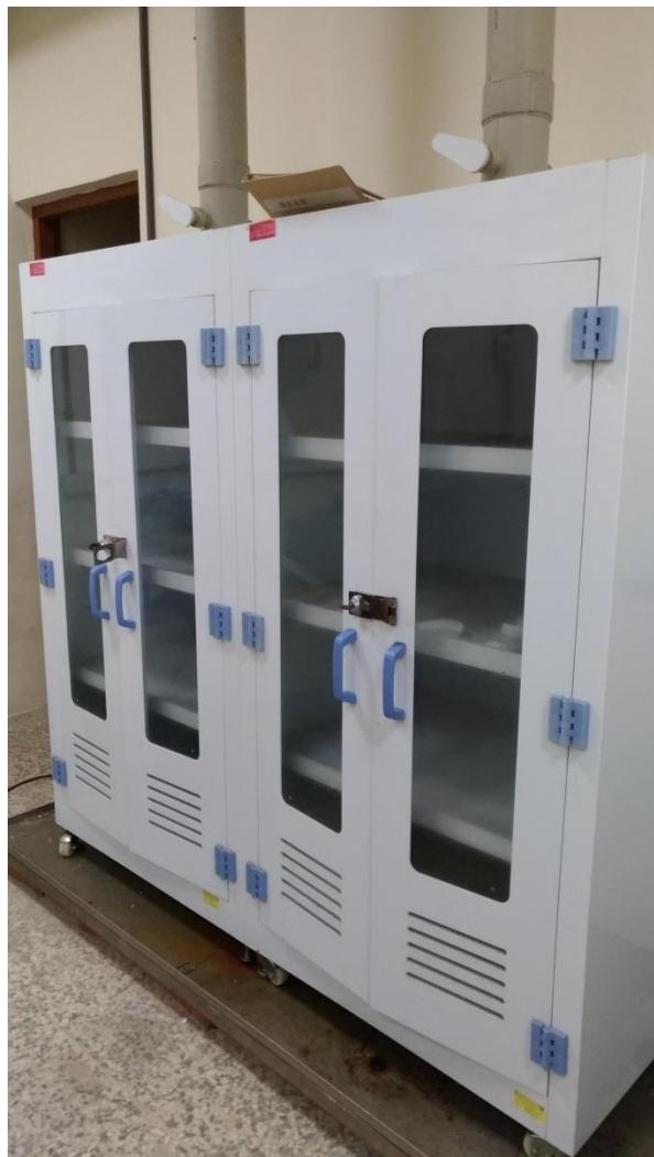
照片為抽氣櫃/抽氣式藥品儲存櫃因使用期限過長已失原有效能，如擬領用，外側鑰匙已鏽蝕需自行更換，儲存櫃內部間格固定無法調整，抽氣系統需自行配置。
