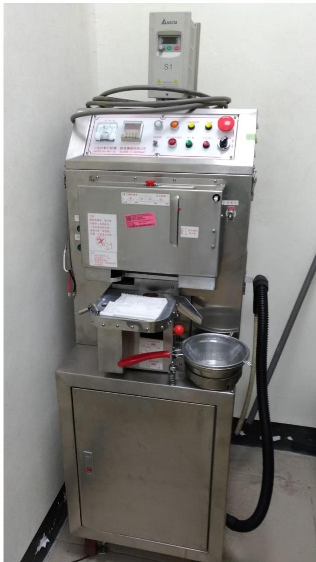
照片為油壓冷壓機/自動觸媒成型機，只能壓製單一不規則小尺寸條狀顆粒需另配電源，因長期未用已失原有效能，如擬領用，設備請另行找廠商檢修。
