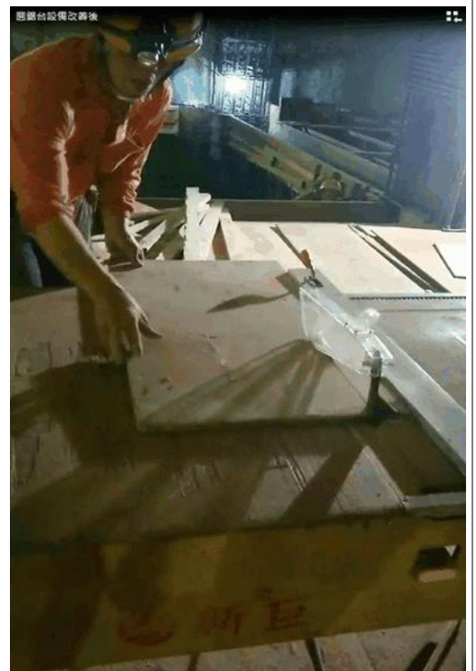
木材加工用圓盤鋸應設置覆蓋等防護設施(改善後)。
