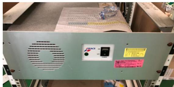
右圖為即時高溫氣體分析儀，該設備年久失修，已無法正常執行其功能，且相關附屬紅外線光譜分析儀、氣體調理裝置、氫氣分析儀等設備老舊除失去精度外，已無法與試驗設備連線。左圖為燃料電池模擬工作站，該設備老舊且失去其效能。以上設備若無領用，擬將逕行辦理報廢。
