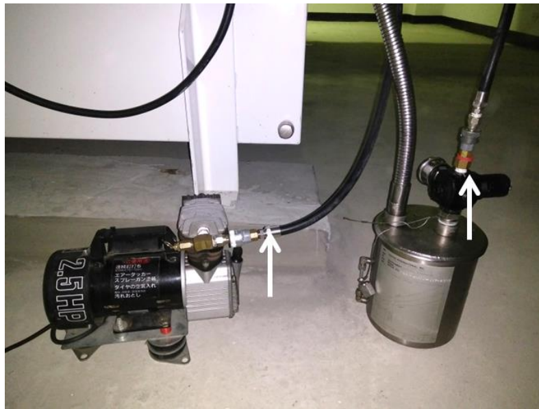
連接空壓機與氣膠產生器
