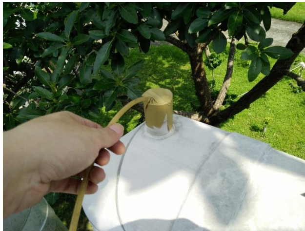
鹵化物氣體放樣管放置空氣過濾器系統放樣口
