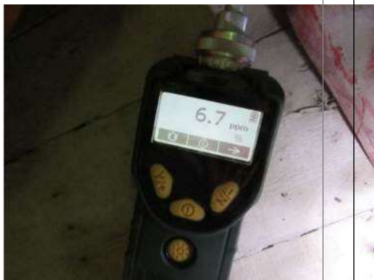
汙廢水池防蝕工程現場測量有機溶劑濃度為 6.7ppm
