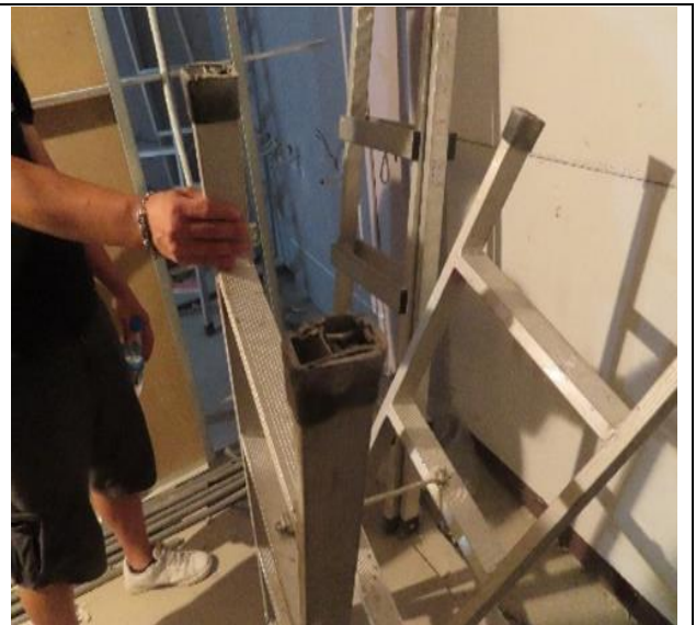
使用之合梯四腳腳部絕緣已磨損
